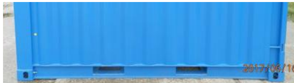
Passage de fourches entraxe 950mm
